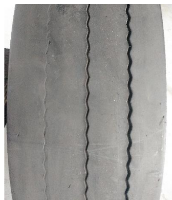
Imagem 1: Aparência de um pneu com desgaste em apenas um dos ombros.
