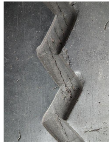
Imagem 1: Exemplo de ressuscitação excessiva, onde é possível ver a cinta de aço mais externa.
