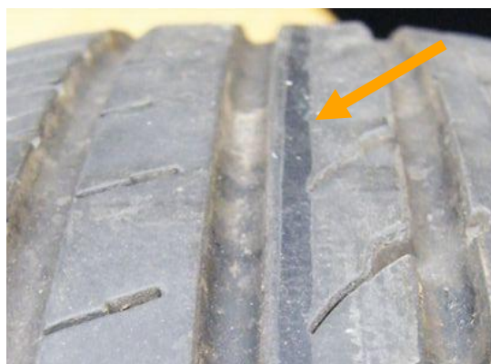
Imagem 1: Exemplo da banda de rodagem de um pneu mostrando o feixe central de negro de fumo.
