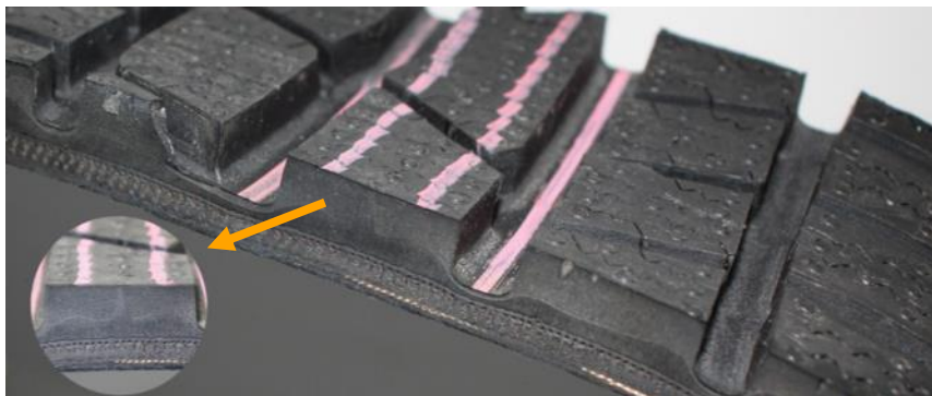
Imagem 2: Seção real de um pneu mostrando a diferença entre os compostos de sílica e negro de fumo.
