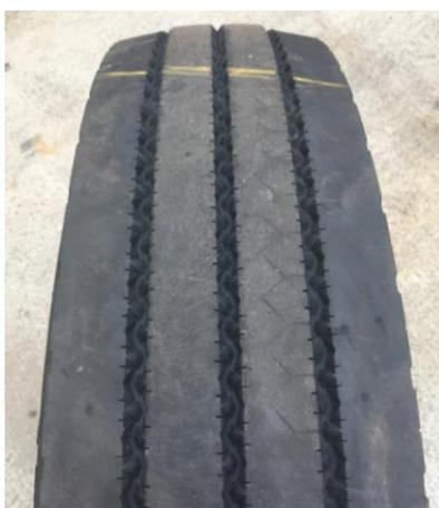
Imagem 2: Aparência de um pneu com desgaste nos ombros.
