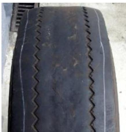
Imagem 1: Aparência de um pneu com desgaste no centro da banda de rodagem.
