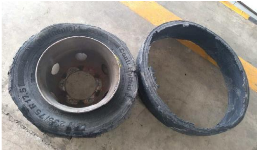
Imagem 4: Aparência de um pneu com degradação severa e separação total dos componentes, devido a rodagem com baixa pressão.
