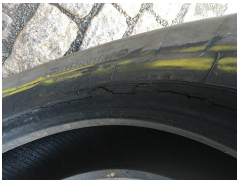
Imagem 2: Condição do Imprinting, que em casos extremos ocasiona trincas na região do talão.
