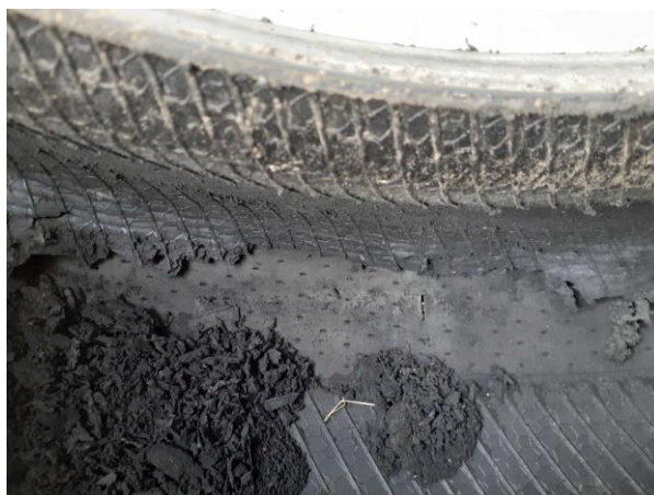
Imagem 1: Aparência de um pneu com o liner desagregado devido a utilização em baixa pressão.
