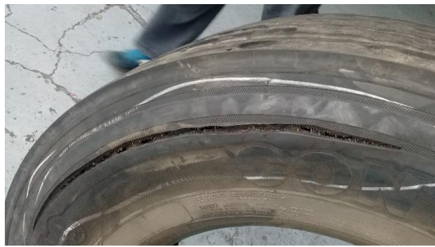
Imagem 3: Condição de Zipper Break, onde há uma ruptura na zona de flexão do pneu.
