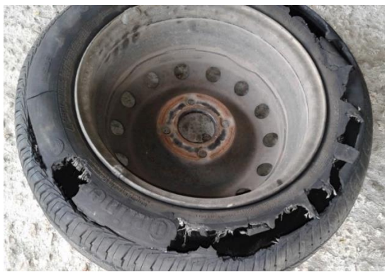
Imagem 3: Aparência de um pneu com degradação severa e separação total dos componentes, devido a rodagem com baixa pressão.
