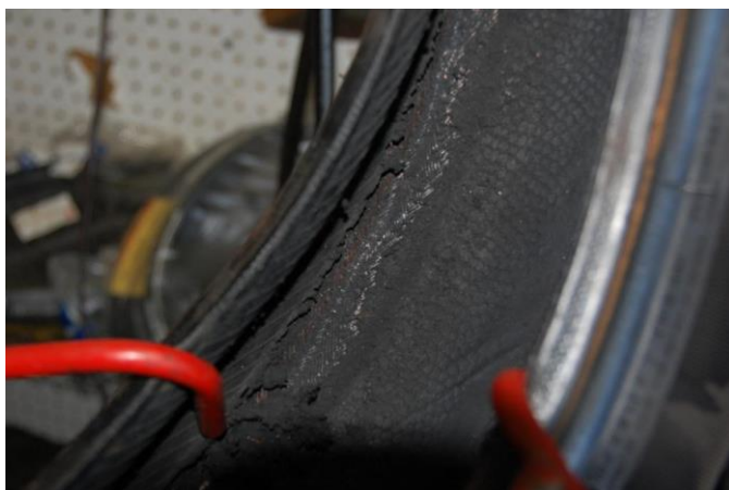
Imagem 1: Aparência de um pneu com o liner degradado devido a utilização em baixa pressão.
