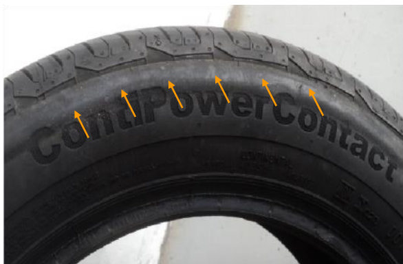
Imagem 2: Marcação circunferencial na lateral de um pneu devido a utilização em baixa pressão.
