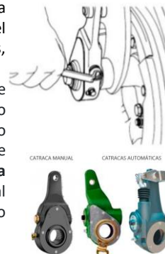
Imagem 3: Catracas de freio Manual e Automáticas
