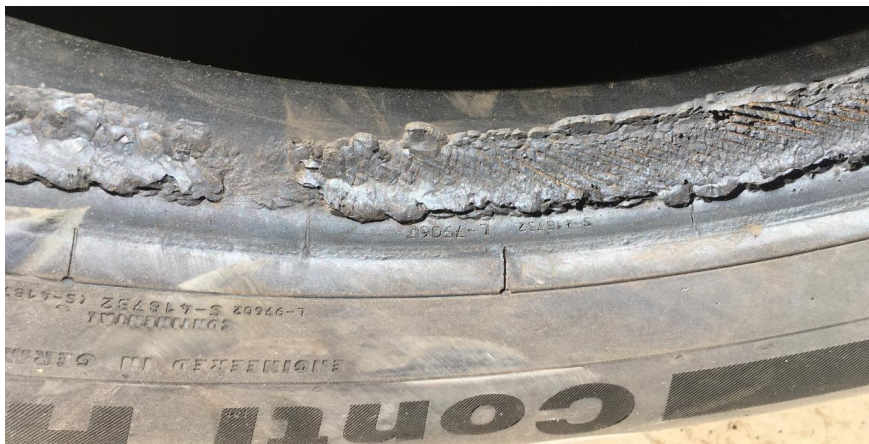
Imagem 7: Aparência de um talão danificado pela temperatura.
