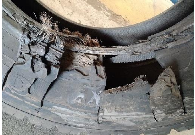
Imagem 6: Aparência típica da condição de ply pull-out .
