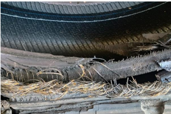
Imagem 9: Fios expostos com borracha somente na base.
