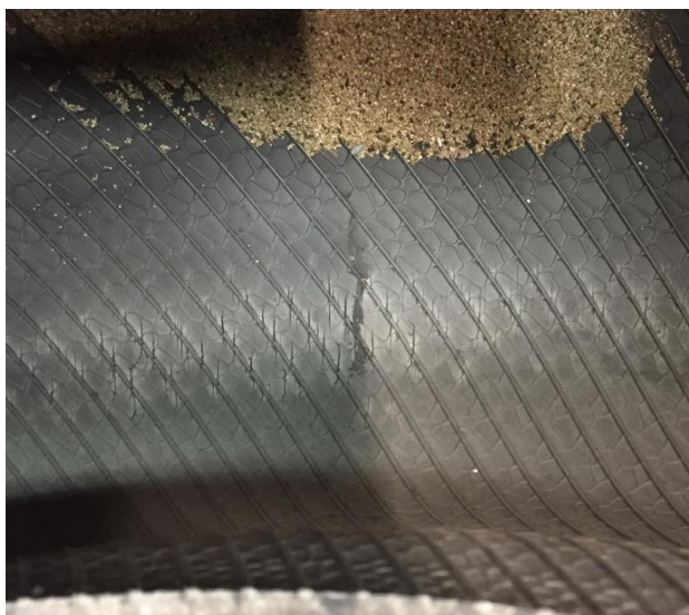
Imagem 1: Rachaduras no liner causadas pelo composto usado para o balanceamento interno.
