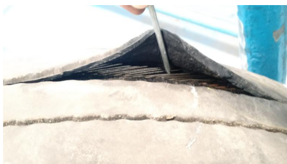
Imagem 2: Separação na extremidade das cintas estabilizadoras.
