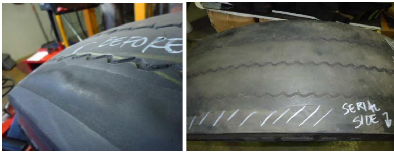
Imagem 4: Separação na extremidade das cintas estabilizadoras, causada pelo desgaste irregular da banda de rodagem.
