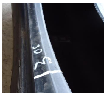
Imagem 3: Separação na extremidade das cintas estabilizadoras, causada pela deformação do talão decorrente do assentamento incorreto.
