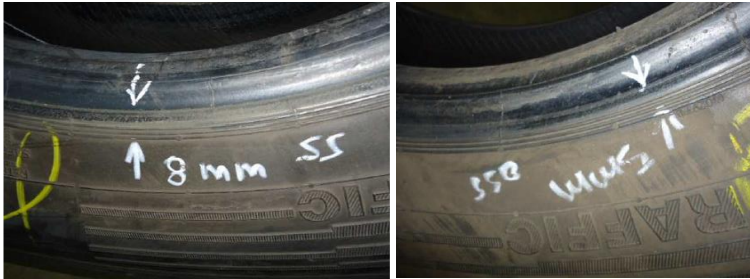
Imagem 5: Deformação na lateral dos pneus e separação das cintas estabilizadoras, causada pela sobrecarga do veículo.
