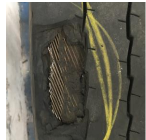
Imagem 6: Separação das cintas estabilizadoras, causada por contaminação de um reparo inadequado.
