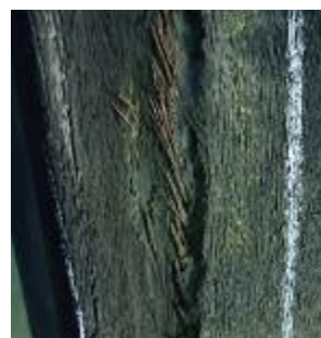
Imagem 3: Separação na extremidade das cintas estabilizadoras, causada pela deformação do talão decorrente do assentamento incorreto.
