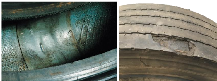
Imagem 6: Separação das cintas estabilizadoras, causada por contaminação de um reparo inadequado.
