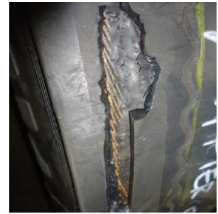
Imagem 4: Separação na extremidade das cintas estabilizadoras, causada pelo desgaste irregular da banda de rodagem.
