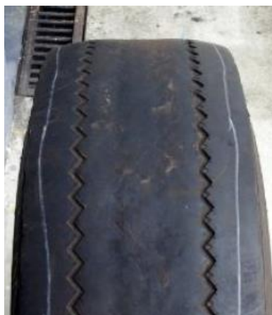
Imagem 2: Desgaste irregular causado por pressão de inflação excessiva.
