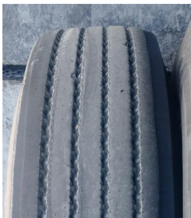
Imagem 1: Desgaste irregular causado por baixa pressão de inflação.
