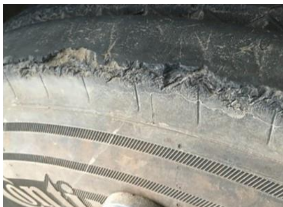
Imagem 2: Picotamento na região do ombro, causado pelo arraste dos pneus em manobras e/ou desalinhamento.
