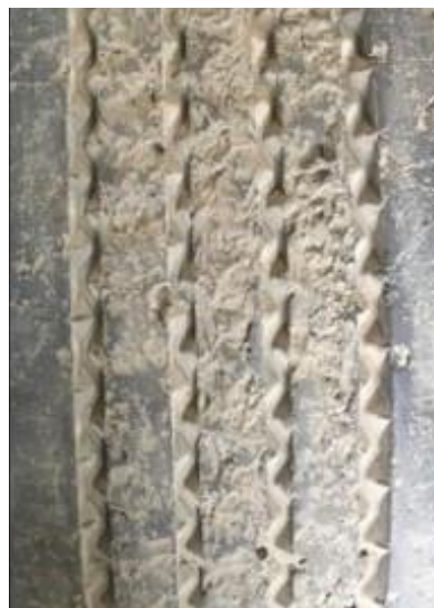
Imagem 1: Aparência típica da condição de picotamento em um pneu de carga.
