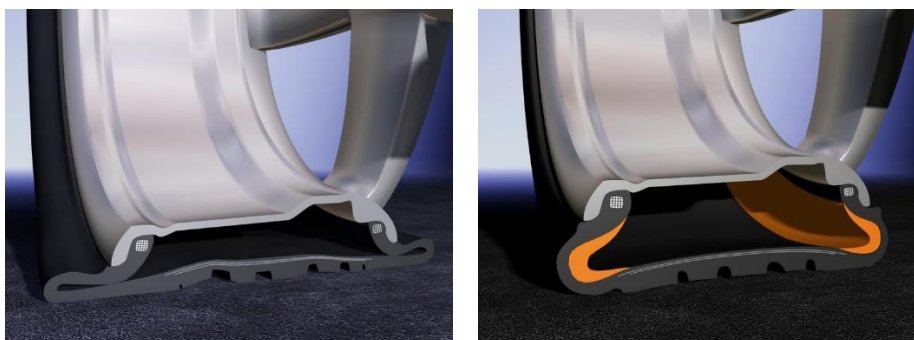
Ilustração 2: Comparação das estruturas dos pneus, quando submetidos à baixa pressão de inflação: na esquerda, um pneu convencional; na direita, um pneu SSR.
