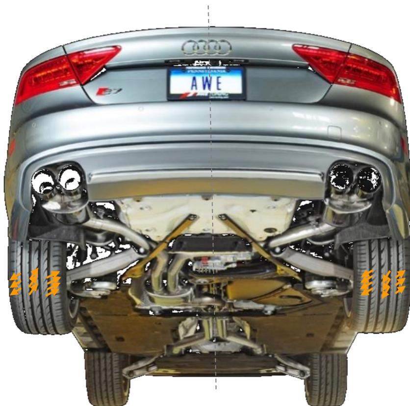
*Ilustração 1: Aparência de pneus assimétricos montados no veículo. A linha tracejada é a linha de simetria do veículo.*
