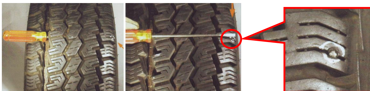
Imagem 3: Contaminação gerada por um furo na banda de rodagem.
