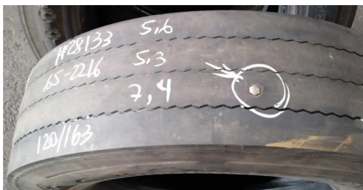
Imagem 1: Exemplo de uma perfuração em um pneu de carga.
