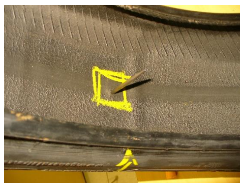
Imagem 2: Exemplo de uma perfuração em um pneu de passeio.
