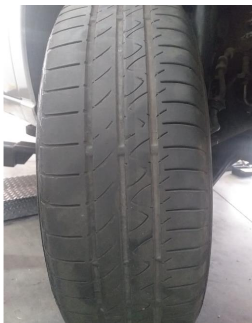
Imagem 1: Pneu com desgaste na banda de rodagem que já atingiu o TWI.
