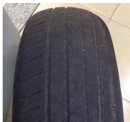
Imagem 1: Aparência de um pneu com desgaste em apenas um dos ombros.
