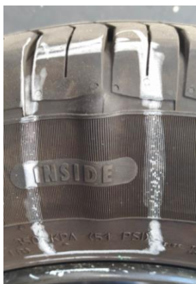
Imagem 1: Bolha proveniente de um impacto na lateral de um pneu.
