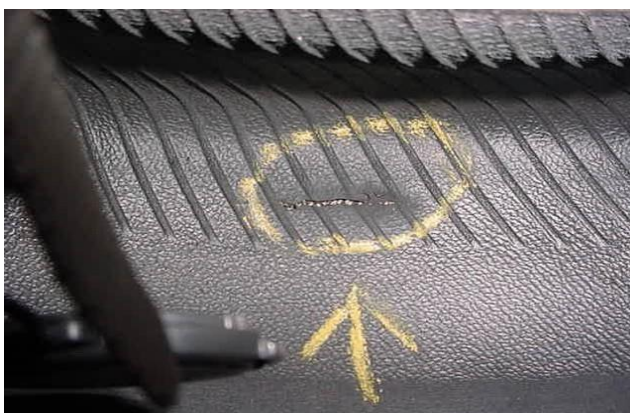
Imagem 2: Marca na parte interna do pneu, na mesma região da bolha.
