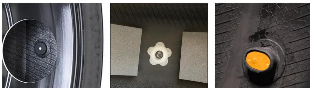
**Figura 1: Exemplos de Sensores montados em pneus**
