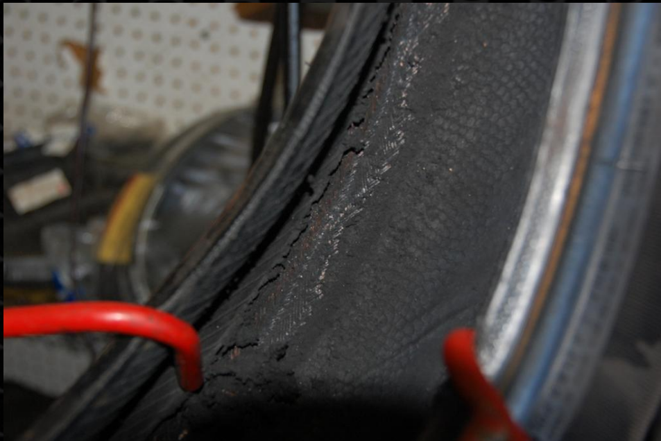
Aparência de um pneu degradado pela rodagem sob baixas pressões.
