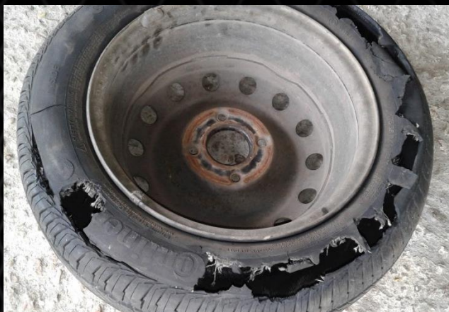
Aparência de um pneu com degradação severa e separação total dos componentes, por rodagem com baixa pressão.
