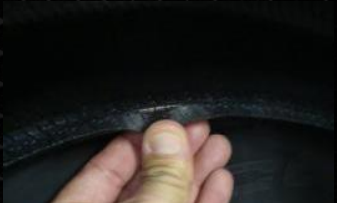
Dano causado por montagem inadequada que pode gerar uma bolha lateral.
