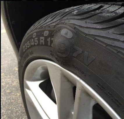
Dano lateral causado por impacto. Nestes casos, é comum encontrar marcas na camada estanque também.
