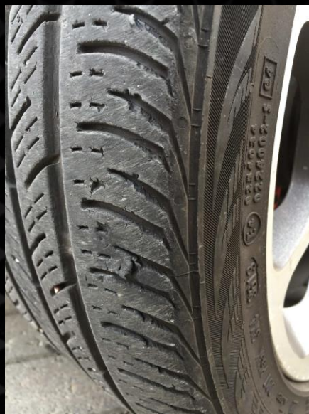
Exemplo de banda de rodagem com arrancamentos.
