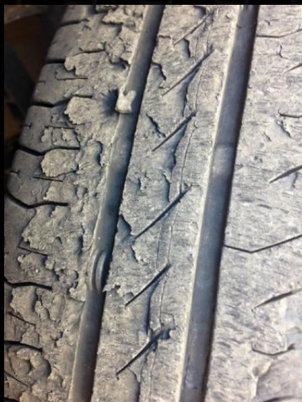
Exemplo de banda de rodagem sob ação de delaminação.
