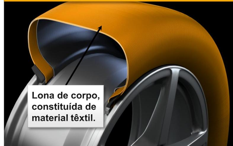
Lona de corpo é a estrutura utilizada para construir a carcaça do pneu. A carcaça é o que sustenta o peso total do veículo e toda a pressão interna do pneu, esta estrutura é constituída de lona têxtil, como Rayon, Nylon ou poliéster, para os pneus de passeio, SUV, pick-up e van. No caso dos pneus de carga esta estrutura é constituída de aço.
