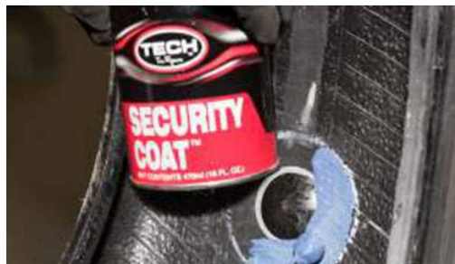
Figura 30. Aplicación del sellador
