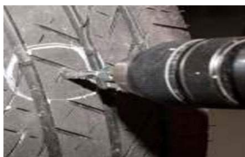
Figura 18. Tratamiento en el exterior del neumático
