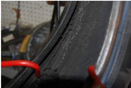
Figura 4. Neumático con revestimiento degradado por funcionar a baja presión
