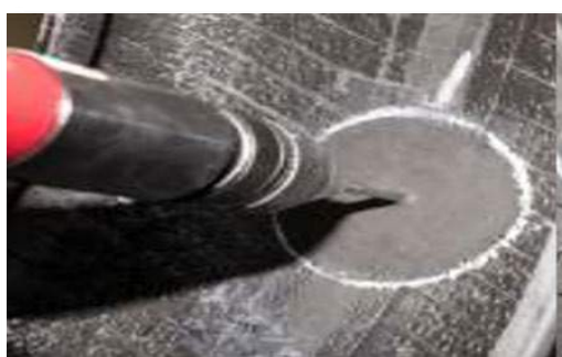
Figura 17. Tratamiento en el interior del neumático
