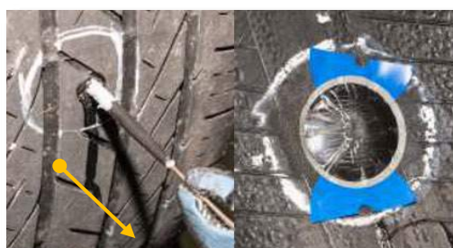
Figura 26. Aplicación de reparación parte externa
